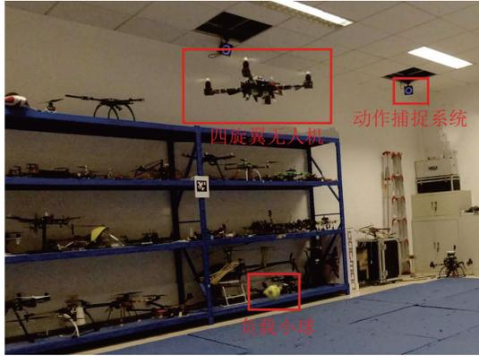
图 3 四旋翼无人机吊挂空运系统实验平台
