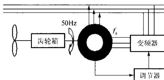
图5 交流励磁双馈发电机示意图
