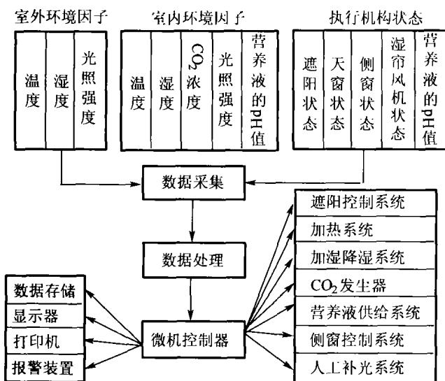
图 8 温室控制系统框图
