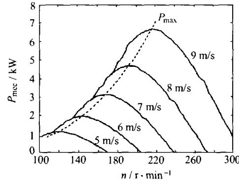
图 4 风力发电机组最大风能捕获控制曲线
