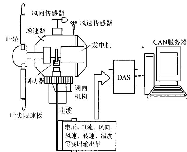
图 1 风力发电机组监控系统
