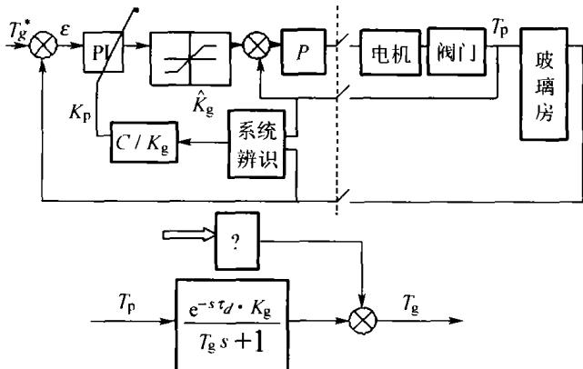
图 9 温室自适应控制供热系统
