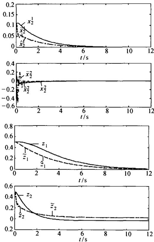
图1 在状态反馈及  $\epsilon = 0.01, \epsilon = 0.05$  时输出反馈下的状态
