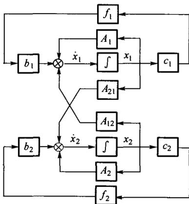
图1 Lurie 控制系统的关联
