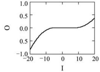
图 6 带死区液压系统的 I/O 特性
