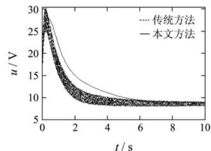
图9 死区补偿后控制量的比较
