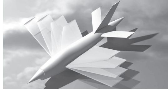
图1 变体飞行器后掠变形示意图
