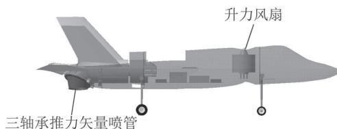
图 2 F-35B缩比飞机模型侧图
